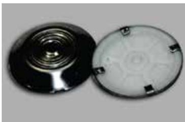
Este produto é constituído por um núcleo de PBT (polibutilenotereftalato) revestido com uma capa de aço inoxidável ABNT 304. A capa de inox é produzida por estampagem a frio. Na superfície do topo do sinalizador existem nervuras para aumentar a rugosidade e promover maior aderência com efeito anti-derrapante.
